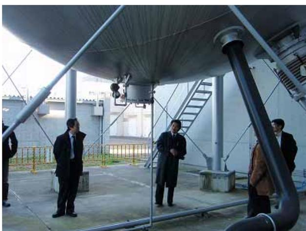
風洞下流側に接続される球形真空タンク、上流側には高圧タンクがある
