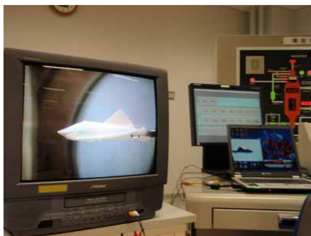
コントロール室のモニター画面, シュリーレン画像で観察可能
