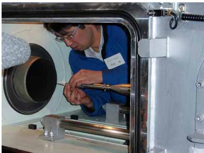
計測支柱に折り紙ヒコーキを取り付ける
