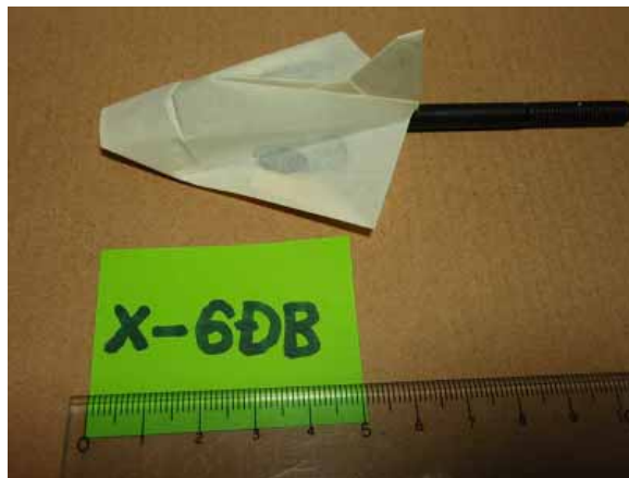
X -6DB 二段尾翼型 このモデルは2回の耐久試験に使用した 胴体部含む翼面積 2336.5平方 mm
