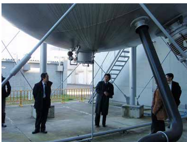
風洞下流側に接続される球形真空タンク、上流側には高圧タンクがある
