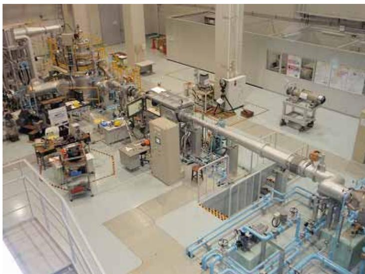
風洞装置の中央計測部
