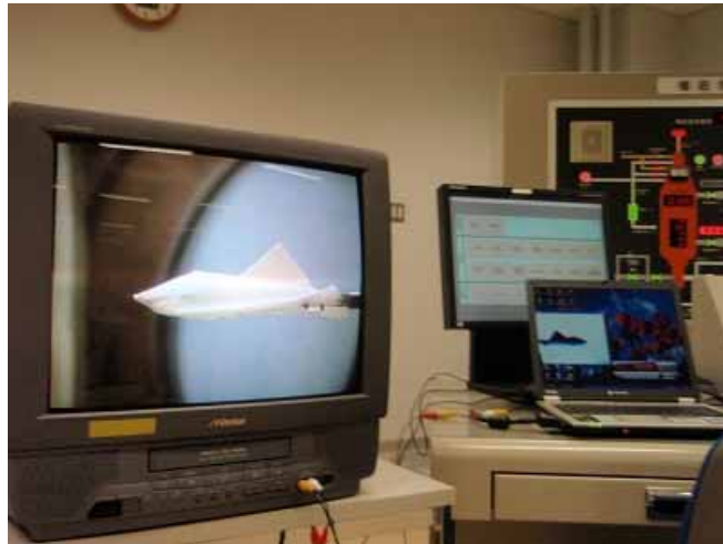
コントロール室のモニター画面, シュリーレン画像で観察可能
